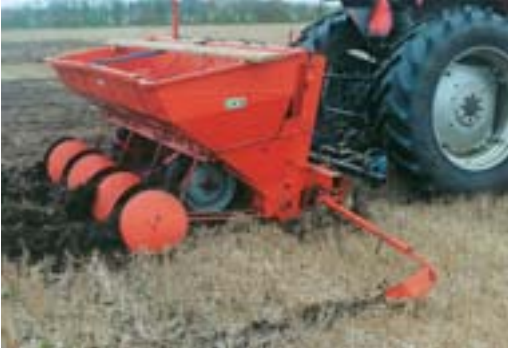
Direkte lægning af kartofler i stub. Foran læggemaskinen brydes jordskorpen ganske let med harvetænder, så der kan hyppes jord over kartoffelknoldene.
