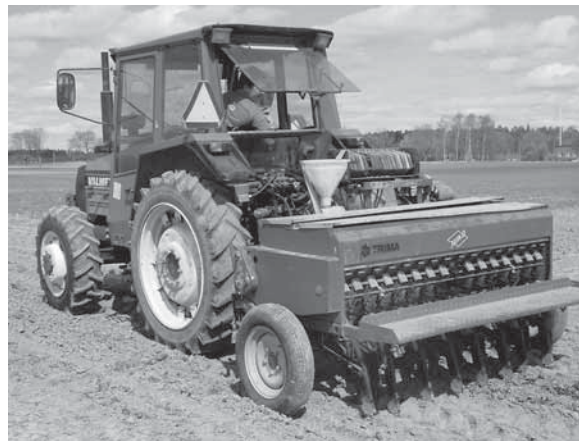
Figur 1. I projektet används en kombisåmaskin som har modifierats för att klara såväl kornad konstgödsel som vinass.
