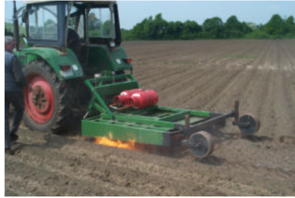
Abb. 3: Abflammgerät im Einsatz
