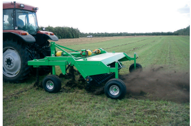
Sønderdeling og oprykning af kvikudløbere ved hjælp af et nyudviklet redskabsprincip kaldet KvikUp-harve
