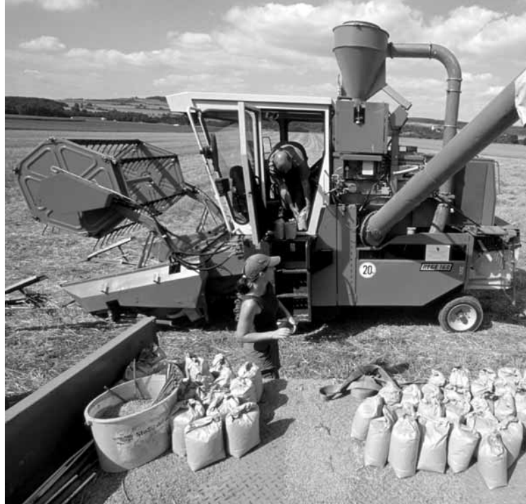
■ Abb. 3: Eine stärkere Vernetzung soll dazu beitragen, die Ergebnisse aufwändiger Forschungsarbeiten – hier ein Spezialmähdrösch zur schlagweisen Ernte von Versuchspartikeln – effizienter zu nutzen. (Foto: BLE, Bonn/Thomas Stephan)
