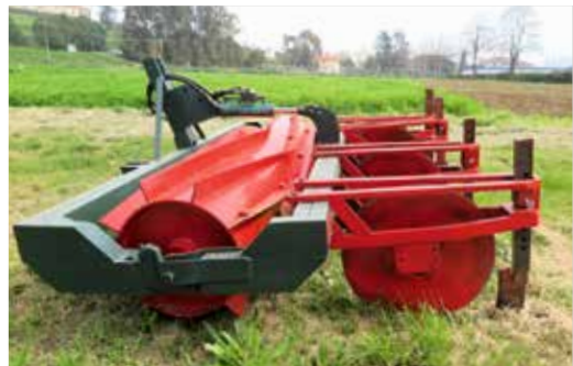
Prototype: rouleau à lames qui trace le sillon de plantation.
