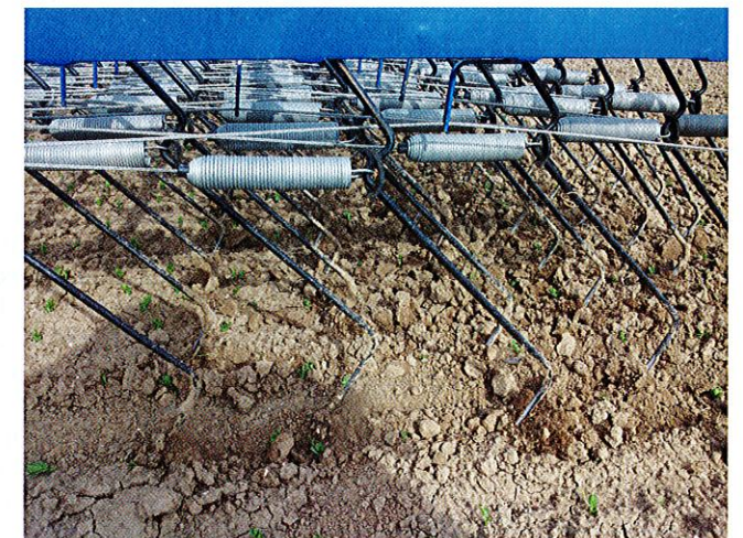
Vor rund zehn Jahren entwickelte ein bayerischer Bio-Bauer zusammen mit der Firma Treffler einen komplett neuen Strieigeltyp, der indirekt gefederte Zinken besitzt. Foto: Treffler
