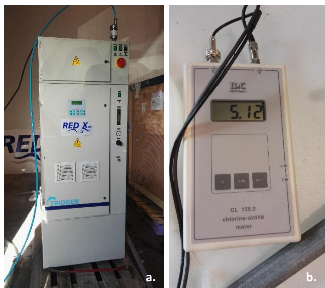
Bilde 2. a: Ozongenerator av merket Triogen b: Håndholdt «Chlorine-ozone meter» av typen B&C Electronics CL 125.2.
