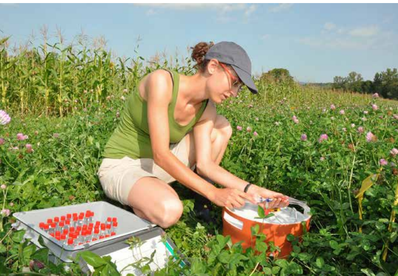
Treibhausgasmessung im FiBL-Versuch in Frick mit dem Ziel, den Einfluss der reduzierten Bodenbearbeitung im Biolandbau auf Lachgasemissionen zu ermitteln. (Foto: Thomas Alföldi, FiBL)
