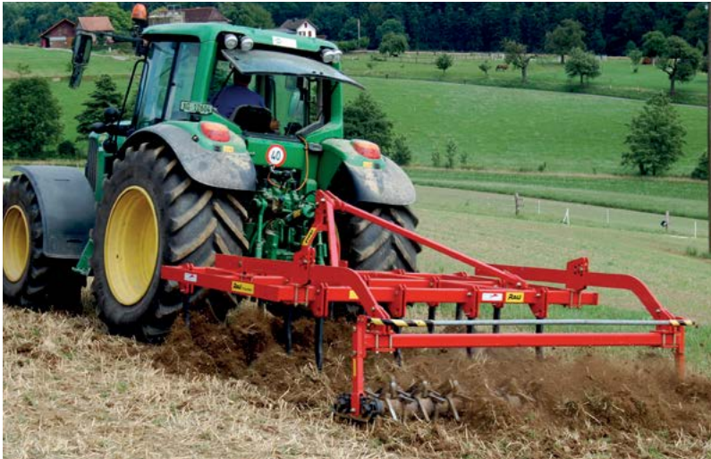
Questo coltivatore con un rullo a doppia stella è un'alternativa all'erpice a dischi. Decompatta il terreno in profondità o superficie. L'attrezzo può montare un lancia-paglia e un erpice per una migliore incorporazione della paglia.
