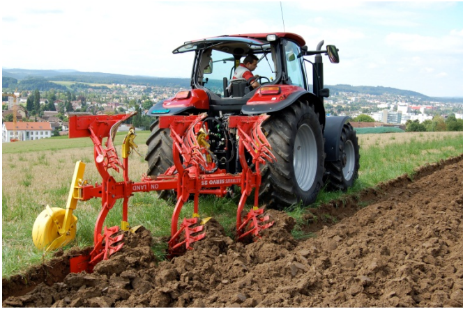
Le labour hors-raie (aussi quelque fois appelé «hors-sillon») aide à éviter les tassements dans la zone de la semelle de labour.
