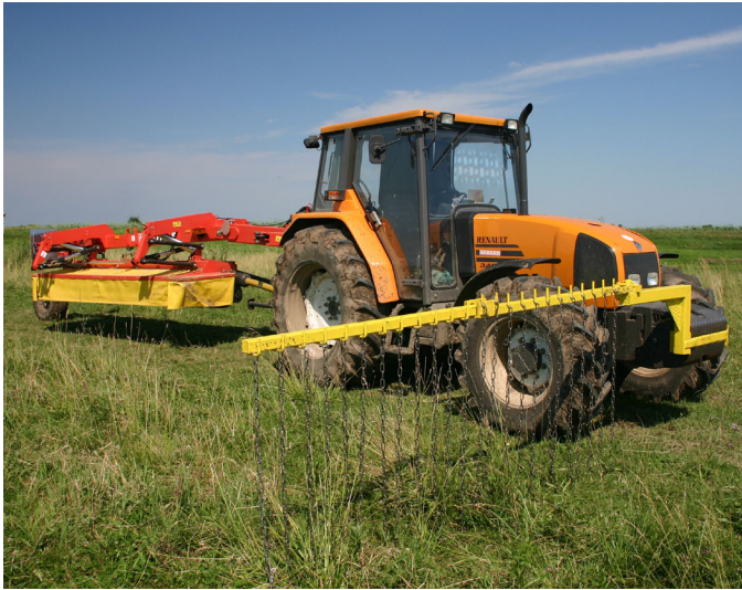
2. kép. Vadriasztóval ellátott dobkasza (Kapocsi I. felvétele)
