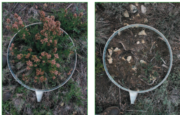
Foto 2. Vista de dos parcelas de lluvia simulada en la Sierra de Enguera. La segunda está cubierta por Erica multiflora . El diámetro de la parcela es de 55 cm.
