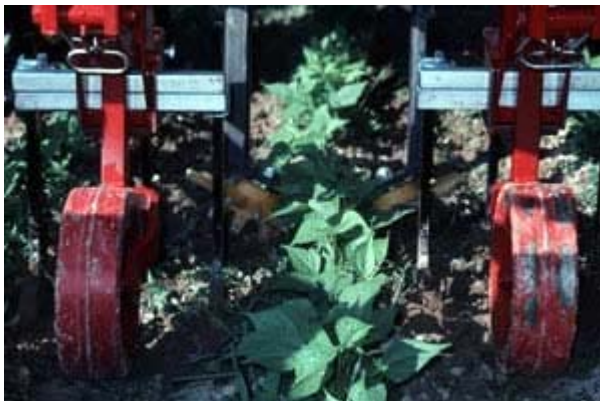
Mit der Fingerhacke können in Bohnen Unkräuter auch in der Reihe gut reguliert werden.
