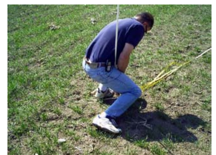
Verankerung von Markierungsstangen.
