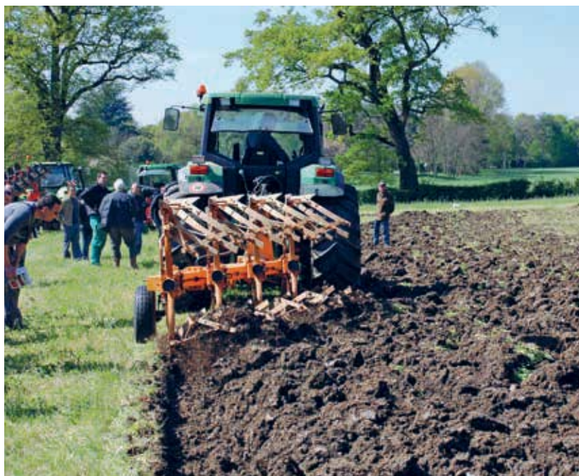
Ein klassischer Riesterpflug, mit einem Stützrad auf reduzierte Bearbeitungstiefe eingestellt.
