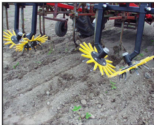
Billede 1. Stjerne-hjulrenser splitter ukrudtet noget og kan klare selv ret stort ukrudt.
