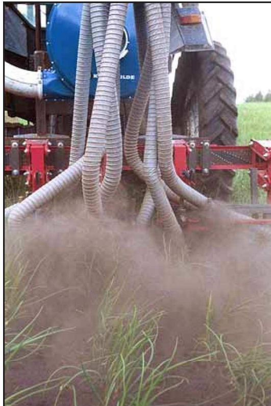
Billede 4: "Løgpusteren" blæser jorden ud af rækken, så der kan hyppes igen. Ideen kan måske bruges i andre afgrøder.
