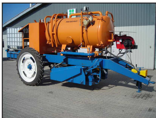
Billede 2. Dampmaskine til rækkedampning, en investering i sparet arbejde.
