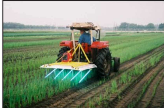
Billede 6 og 7. Ultraviolet lys i store doser slår planter ihjel, i små doser kan det bekæmpe svampesygdomme. Teknikken er under udvikling og pt. ikke godkendt af Plantedirektoratet.
