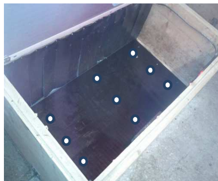
Abb.2: Messung der Temperaturverteilung mittels 9 Sensoren
