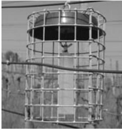
**Herzstück des Passivsammlers ist ein Glaszylinder mit geätzter Oberfläche, auf dem sich die Pestizide niederschlagen.**
