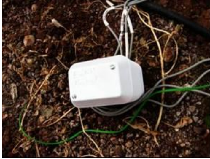
Resim 3.1. Solarizasyon yapılan ve yapılmayan alanlara yerleştirilen sıcaklık ve nem ölçer alet.
