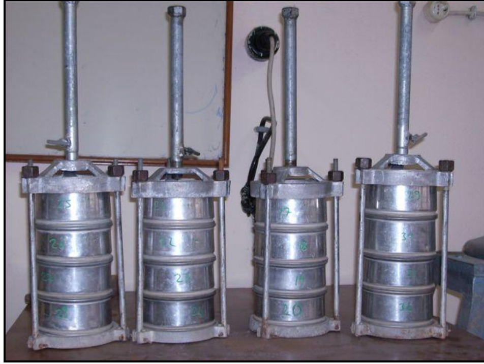
Resim 3.29. Islak eleme yönteminde kullanılan elek takımı.
