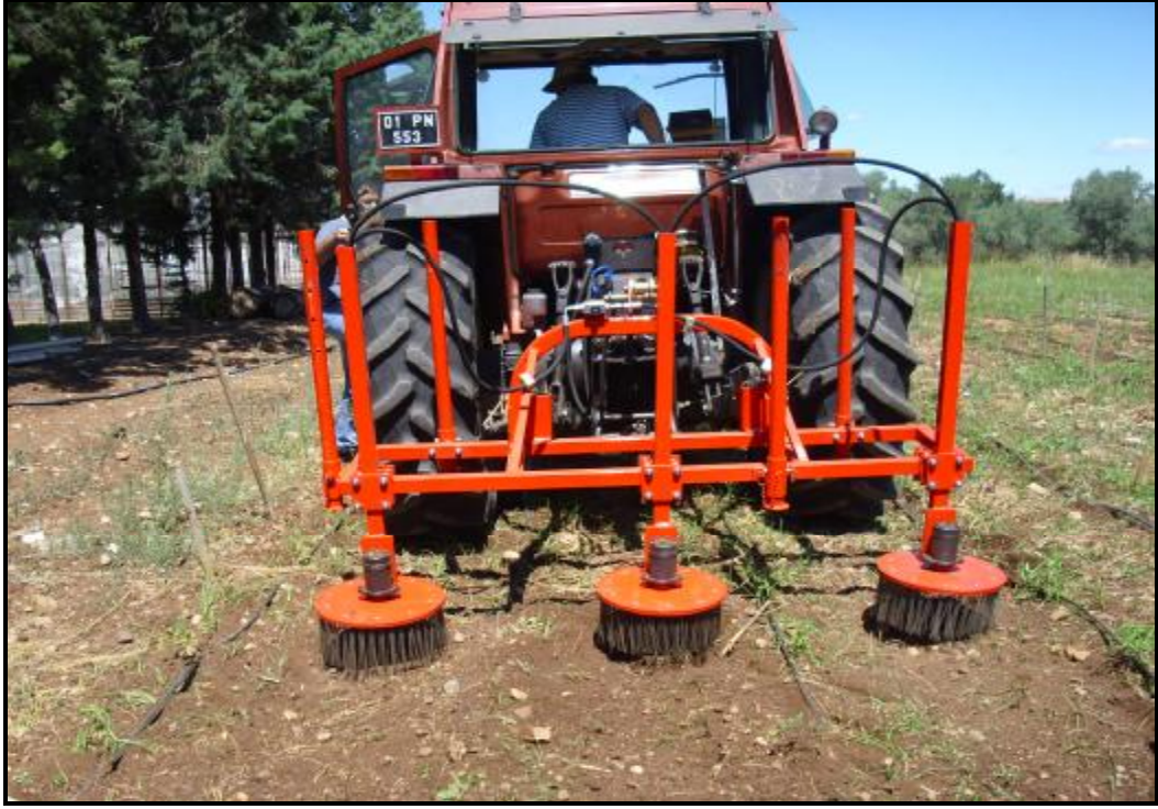
Resim 3.23. Tarla denemelerinde kullanılan yabancı ot fırçalama aleti.
