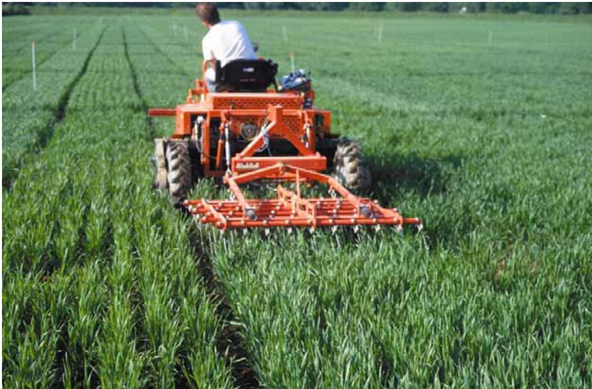
Striegeleinsatz bei Winterweizen (EC 31) in Versuchspartzen (Foto: G. Haas)
