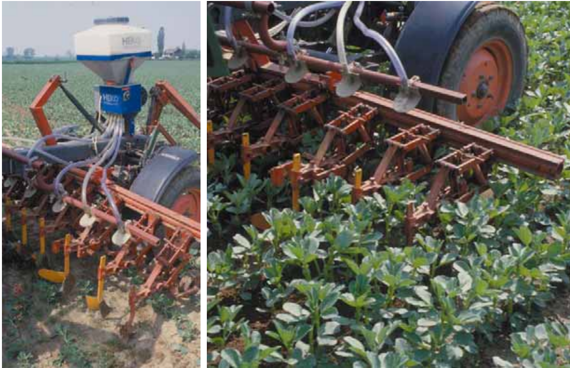
Untersaat Gelbsenf mit dem letzten Hackgang; Pneumatische Sämaschine mit kleinen Häufelscharen (Fotos G. Haas)
