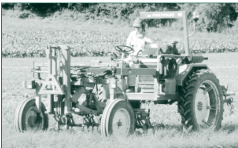
V ekologickém zelinářství se provádějí časté kultivace náročné na přesnost – vhodné jsou samojízdné nosiče náradí
