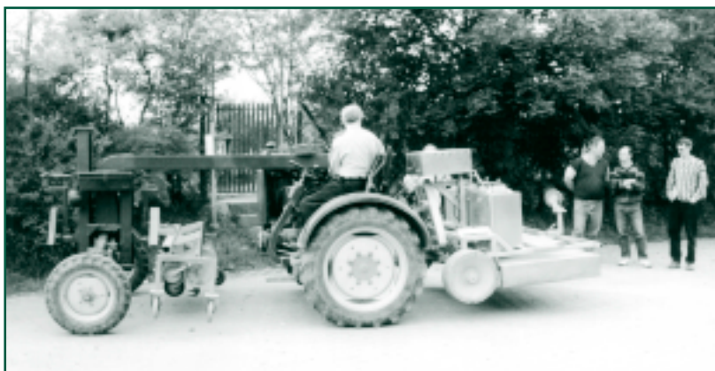
Prototyp nosiče náradí pro záhonový systém pěstování; vzadu termická plečka, mezi nápravami mechanická plečka
