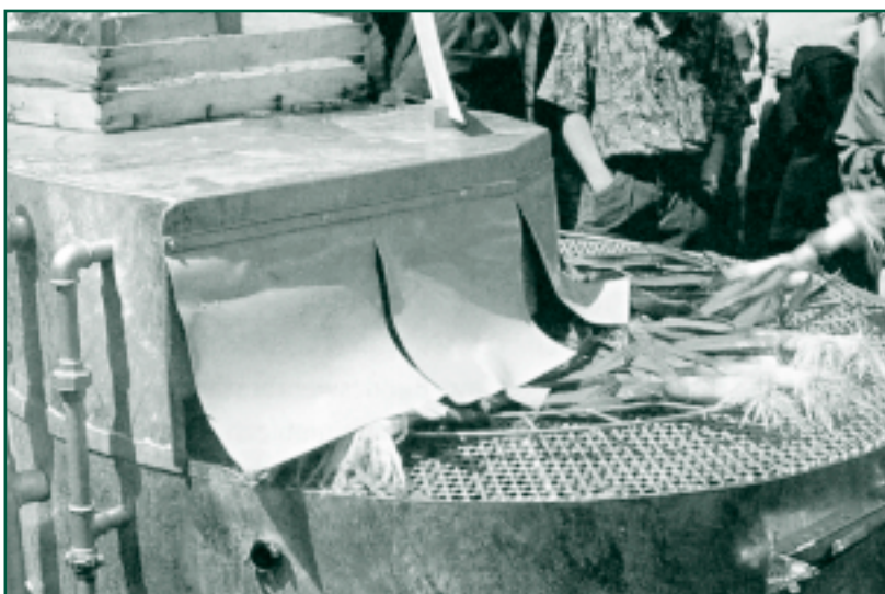
Praní póru v otočné (rotorové) pračce
