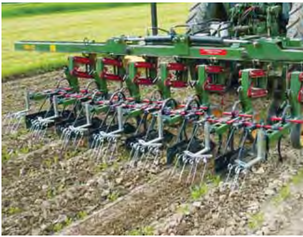
Scharhackgerät mit Kamerasteuerung (Thyregod; Vertretung Daniel Wyss Landtechnik, Ruppoldsriet).
