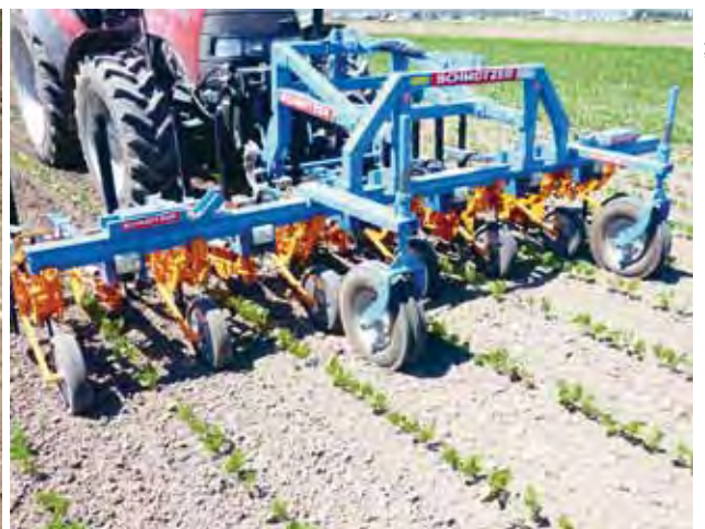
Scharhackgerät gibt es für den Frontanbau (Schmotzer; Vertretung GVS-Fried AG, Koblenz).
