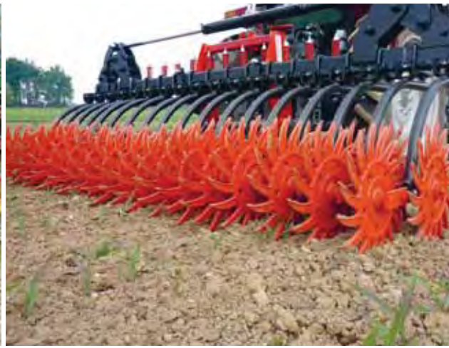
Die amerikanische Rollhacke hat mit 8–12 km/h eine hohe Flächenleistung (Moro; Vertretung GVS-Fried AG, Koblenz).
