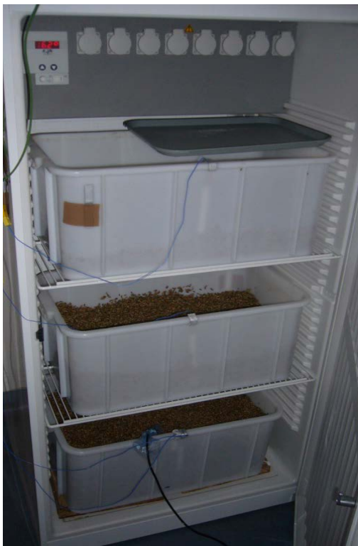
Abbildung 1 Thermoschrank zum Quellen und Keimen des Getreides
