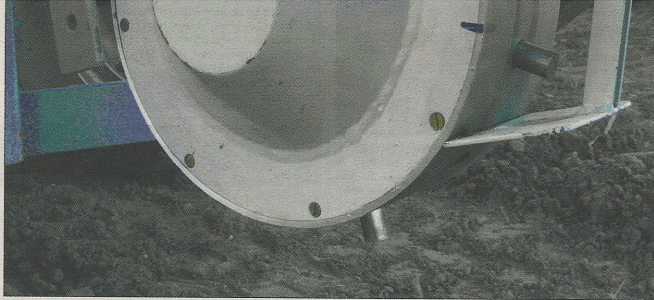
Figur 1. Punktsåningsenhed. E pal presser frøet ned i jorden uden øvrig forstyrrelse af jorden.
