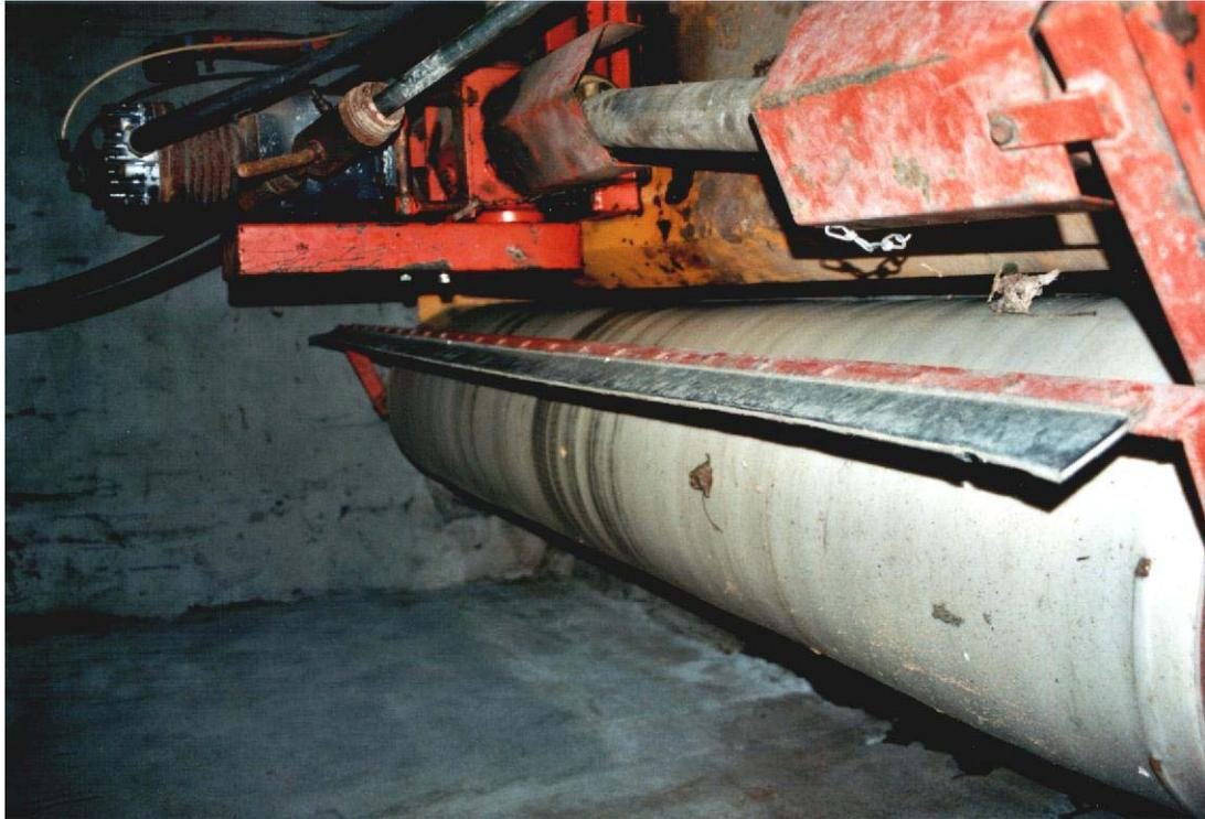
**Abbildung 5:** Um ein Ausgasen zu vermeiden, wird der Boden mit der Walze gegen die Fahrtrichtung verschmiert
