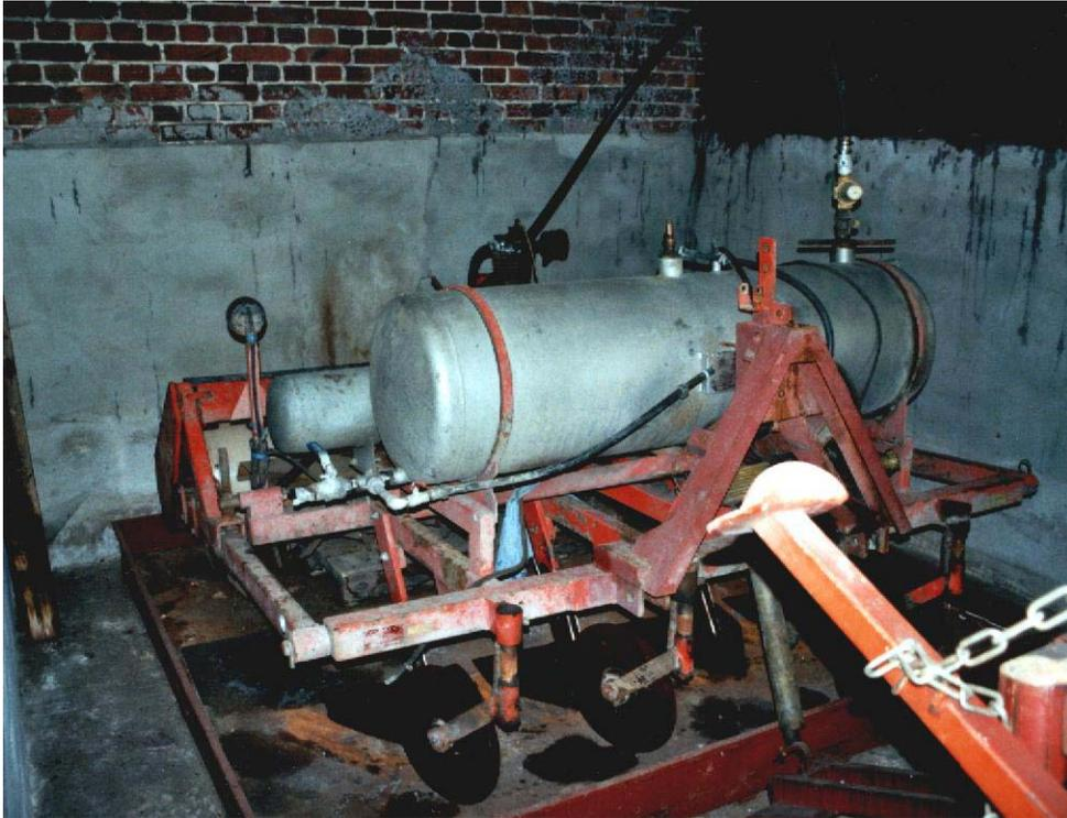
**Abbildung 3:** Spezialpflug zur Ausbringung von Metham Fluid®
