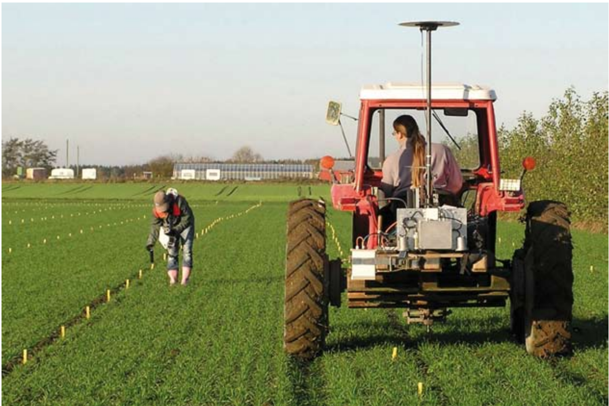
Figur 2. Afgrøde og ukrudt kortlægges ved hjælp af kamera, GPS og billedbehandlingsprogram monteret på traktor i forsøgsmarken på Højbakkegård, KU-LIFE. Efter harvning foretages kortlægningen på ny for at måle effekterne.
