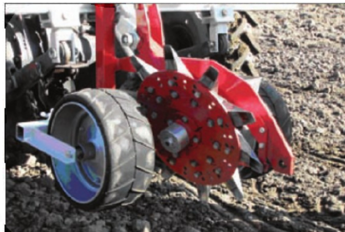
Punktsåningsenhed, hvor frøet falder ned i de huller som stjerneagregatet danner ved fremkørsel.
