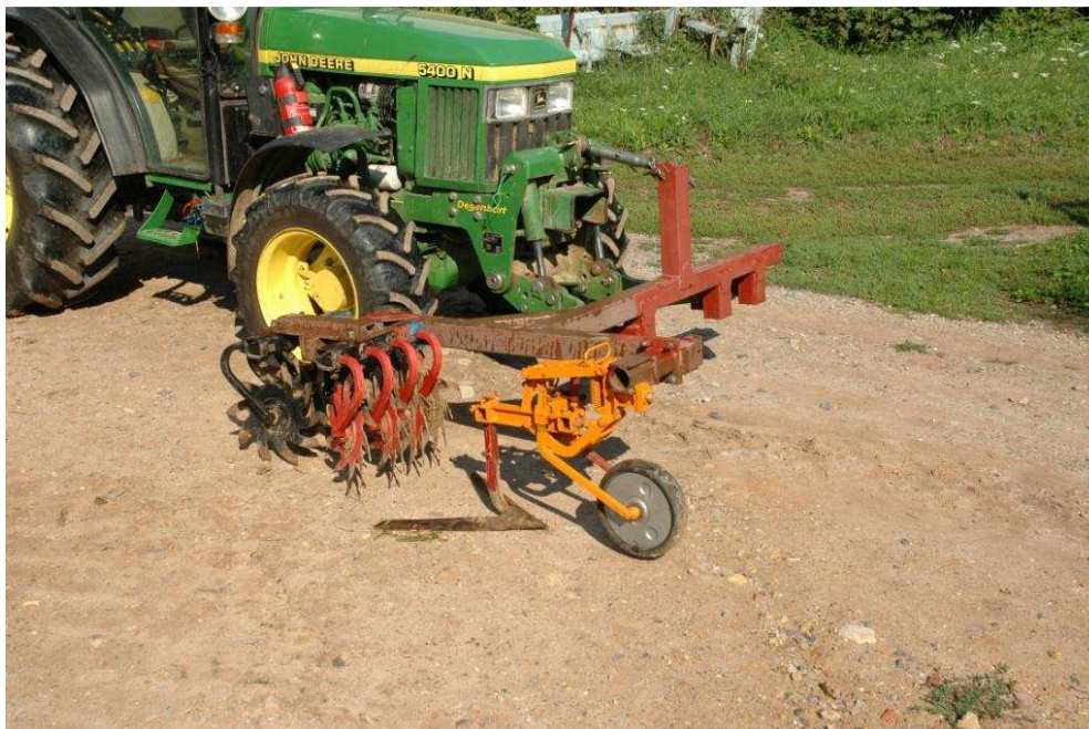
Abb. 42: Eigenkonstruktion am Standort Dresden-Pillnitz, Bodenbearbeitungsgerät zum Sandwichverfahren, Kombination und Gänsefußschar und Sternrollhacken
