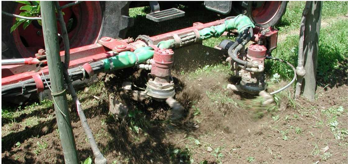
Abb. 6: Steuerbarer Werkzeugarm des Ladurner-Kreiselkrümlers, gut erkennbar der vordere tastarmgesteuerte Kreisel sowie der leicht versetzt dahinter laufende zweite Kreisel
