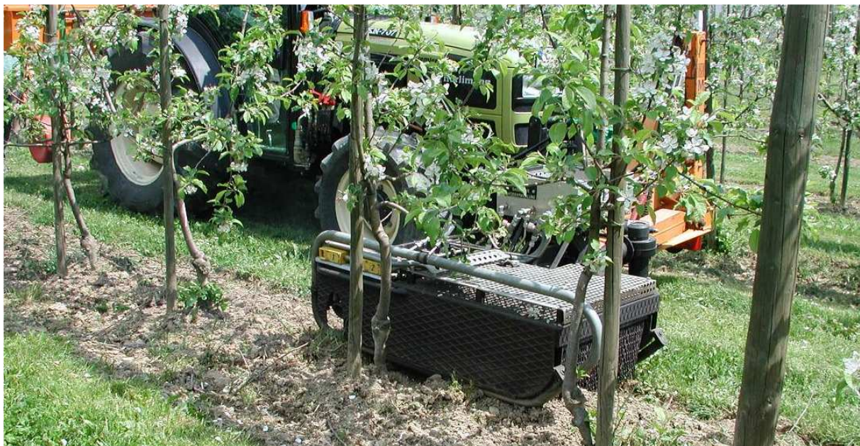
Abb. 1: Abflämmgerät vom Typ „Weihenstephan“, Unkrautbekämpfung mit direkter Flamme
