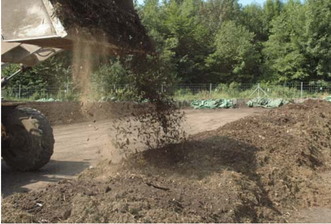
Foto 6 > Durchführung der Nachbehandlungsversuche von Gärgut: Aufbau, Beobachtung des Prozesses, Probenahme
