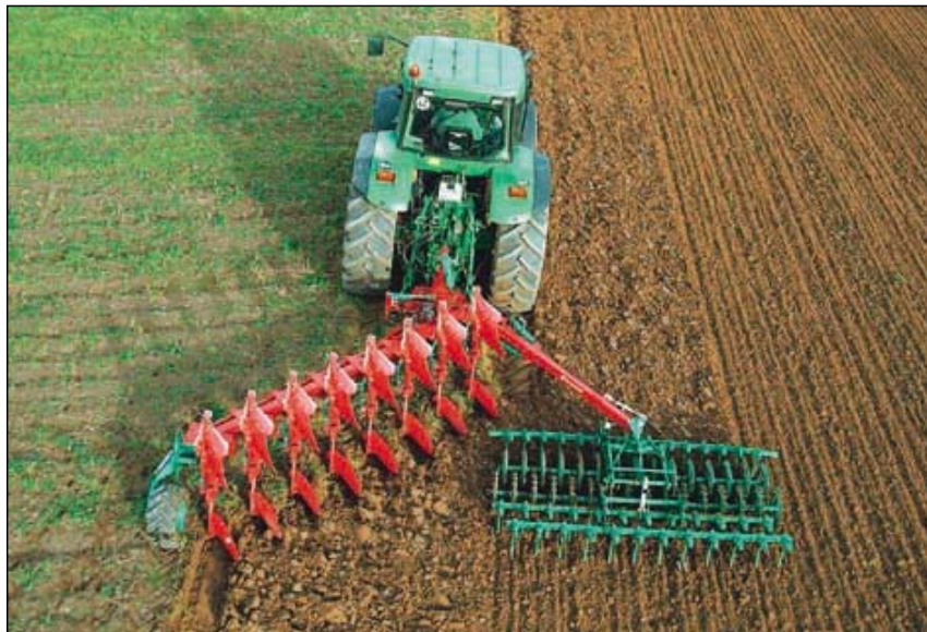
Abb. 4: ECOMAT™-System des Herstellers Kverneland: flach wendende Grundbodenbearbeitung (6-18 cm) mit integriertem Packer zur Saatbettbereitung (Foto: KVERNELAND)
