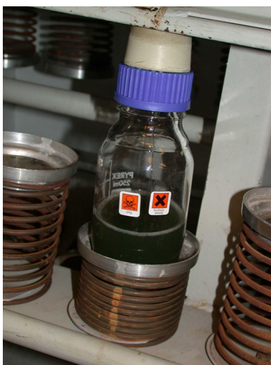
Billede 4.2.5 Rystning af konidiesuspension endoverend med glaskugler
