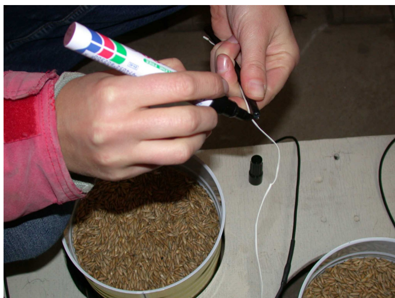
Billede 4.2.15 Temperaturlogger tilpasses dybde
