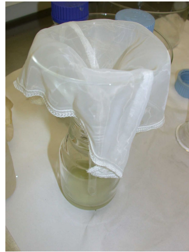
Billede 4.2.4 Filtrering i løst filter
