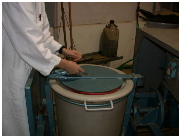
Billede 4.2.14 Opblanding af korn. Låget lægges på jordblander
