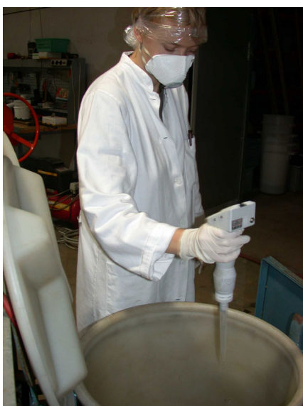
Billede 4.2.10 Tildrypning af konidiesuspension til inokulat
