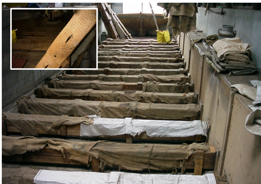
Billede 3.1.1 Oversigt over plantørringsanlæg med hovedkanal og sidekanaler samt bund af sidekanal
