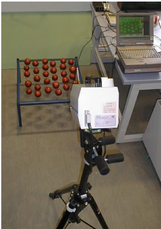
Abbildung 7: Messung von Transpirationswiderständen
