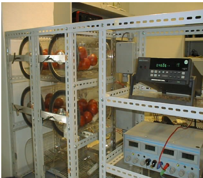
Abbildung 5: Messung von Atmungsaktivitäten
