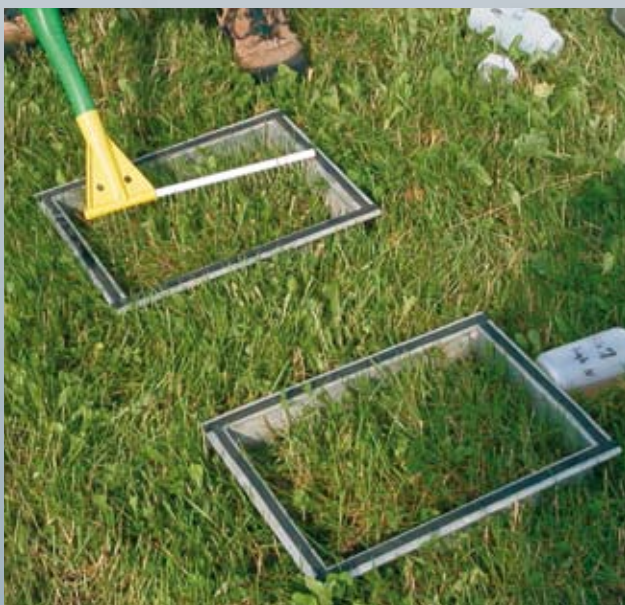
Kontrolleret tilførsel af urin og måling af lattergasdannelsen
