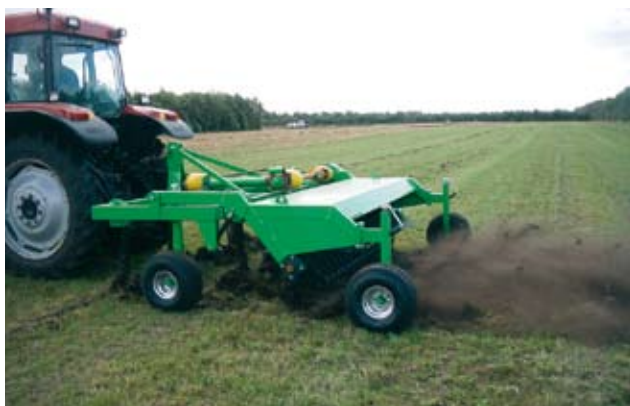
Sønderdeling og oprykning af kvikudløbere ved hjælp af et nyudviklet redskabsprincip kaldet KvikUp-harve
