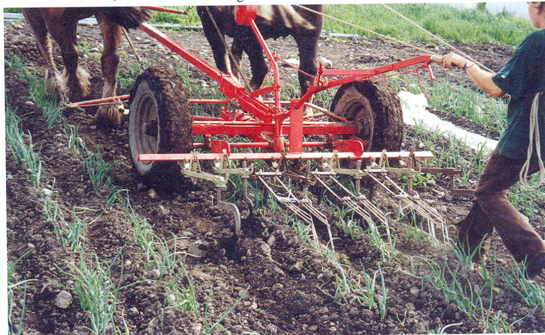
Modernes mit Striegeln bestücktes Vielfachgerät beim Hacken. Mit dem Feinsteuerungshebel können die Werkzeuge so gelenkt werden, dass Schäden an den Pflanzen weitgehend vermieden werden können.
