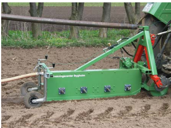
Figur 2. En -rækket forsøgsmaskine til rækkedampning. Til højre gulerødder sået i dampbehandlede bånd. Række nr. 2 fra venstre er ubehandlet, række nr. 3 er 70°C, række nr. 4 er 80 °C mens række nr. 5 er håndluget.
